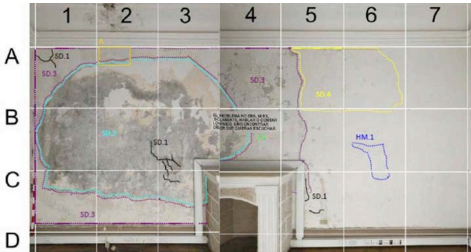
Figura 13. Recinto 108, muro norte. Planimetría de los fenómenos de alteración detectados en superficie: inscripciones (I), huellas y marcas (HM) y síntomas de deterioro (SD). La deformación que presenta el rasgo 5 (chimenea), es producto de puntos de observación diferenciados al momento de la captura que no fue posible solucionar (ver anexo 4: Informe de análisis por imagenología, recinto 108).
